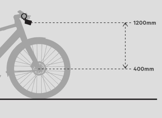
DER SCHEINWERFER MUSS PARALLEL ZUR FAHRZEUGLÄNGSACHSE AUSGERICHTET WERDEN.
