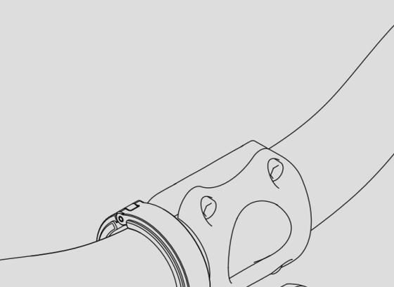
LÖSEN SIE DIE SCHRAUBE AN DER BASIS DER MONTAGE & TRENNUNG AM SCHARNIER.
