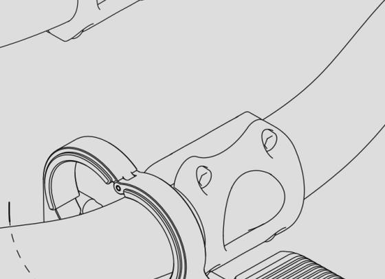
VERWENDEN SIE DEN SECHSKANTSCHLÜSSEL, UM DIE SCHRAUBE FESTZUZIEHEN UND ZU SICHERN AN DAS LICHT MONTIEREN.
